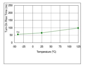
Fig. 24. Turn-on Rise Time vs. Temperature
