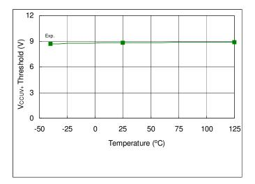
Fig. 30. V<sub>CCUV+</sub> Threshold vs. Temperature
